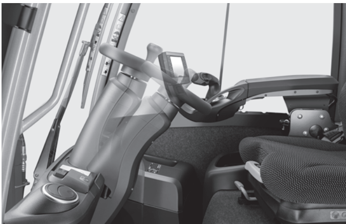
Regolazione individuale del piantone dello sterzo
