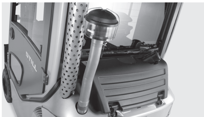
Filtro dell'aria a ciclone per un ingresso d'aria pulito nel motore
