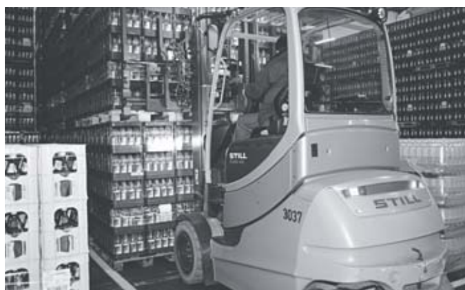
Buona visuale con carichi alti grazie al sedile di guida più elevato
