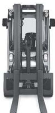
Il montante dal profilo slim garantisce una visuale ottimale sulle forche e standard di sicurezza molto elevati
