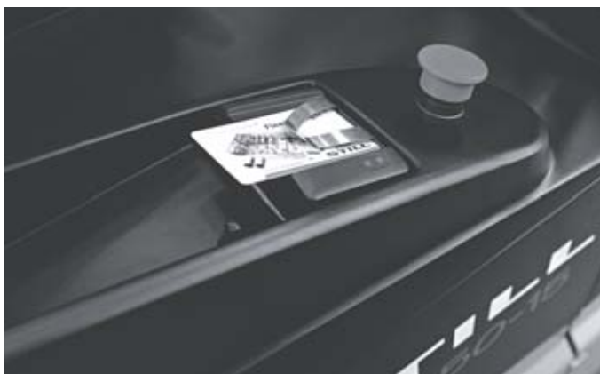
FleetManager 4.x: autorizzazione di accesso con chip card per una sicurezza ottimale
