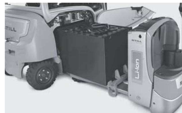
Sostituzione della batteria con transpallet elettrico
