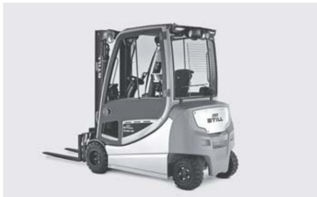
Versione a quattro ruote con cabina di guida completamente chiusa per uso esterno
